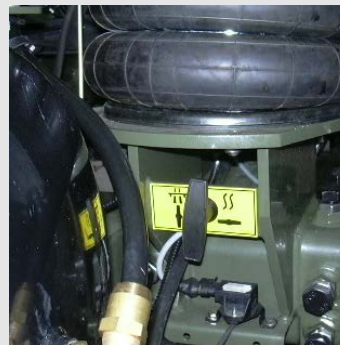
Obrázek 6.139. Rukojeť v silniční poloze (neutralizována funkce vlečené nápravy)
