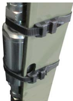
Obrázek 7.16. Možnost DC2, filtr je namontován, umístěn na levém rámu hydraulického bloku
