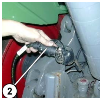
Obrázek 5.50. Napájecí kabely dálkových světel
