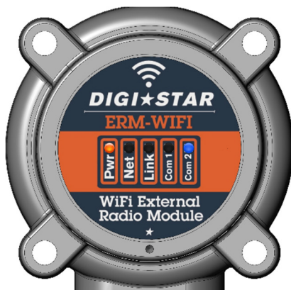
Obr. 7. Modul ERM-WIFI s vypnutým Digi-Star hotspotem
