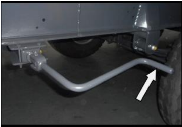
Obr. 18 – páka prevádzkovej brzdy
