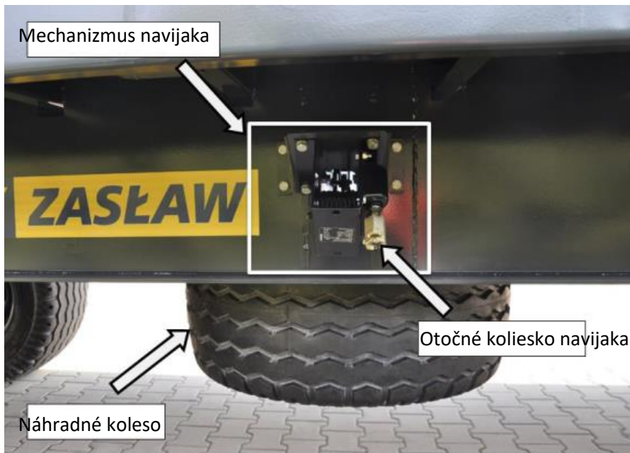
Obr. 12 – Upevnenie náhradného kolesa
