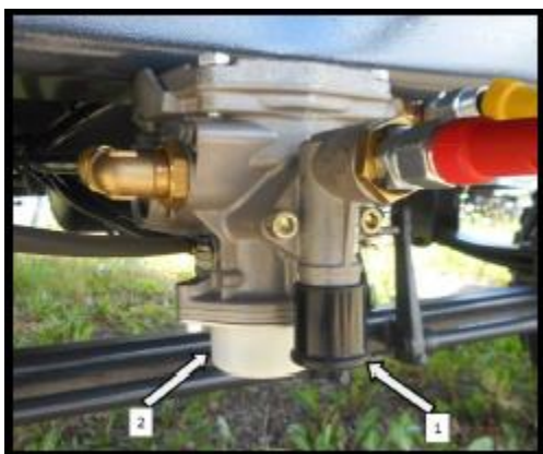
Obr. 15 – umiestnenie brzdiaceho ventilu
