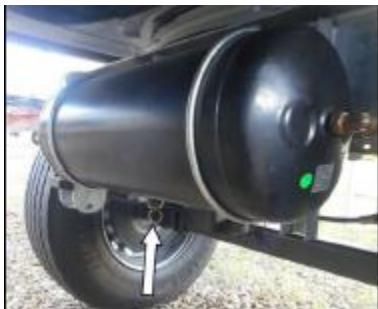
Obr. 11- Umiestnenie odvodňujúceho ventilu na nádrži
