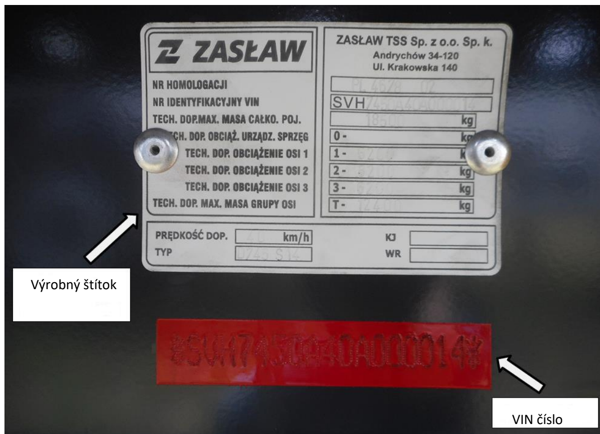
Obr. 1 – Umieszczenie výrobného štítku a VIN čísla.
