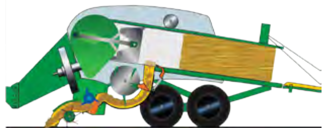
Unikátny variabilný plniaci systém KRONE
