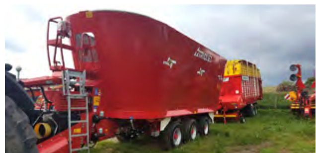
Najväčší krímny voz SOLOMIX 3 - vertikálne závitovky
