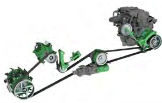
Rezačky KRONE, priamy pohon od motora - žiadne straty v prevodoch, jednoduchá prevádzka a kontrola
