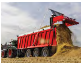
Náves s výtlačným čelom Krampe RamBody 900 s objemom až 52,3 m 3 a náves BiG Body 900 s objemom až 46,1 m 3
