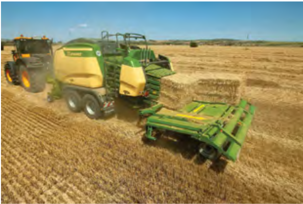
Riešenie BaleCollect - akumuláčny vozík na optimalizáciu ukladania balíkov
