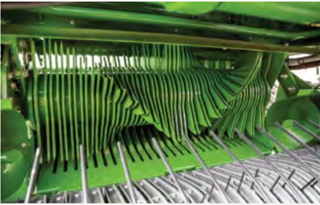
Maximálne výkonné lisy KRONE aj kvôli rezaciemu rotoru aj s meniteľným počtom nožov
