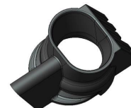
Adaptér senzoru osiva 16mm Tento adaptér zlepšuje funkci při setí sóji s použitím výsevního disku 155273. Adaptér je nyní dodáván spolu s novými disky. Doporučováno pro všechny stroje Tempo k setí sóji s 16mm osivovou trubicí. Kat. č: 223180.
