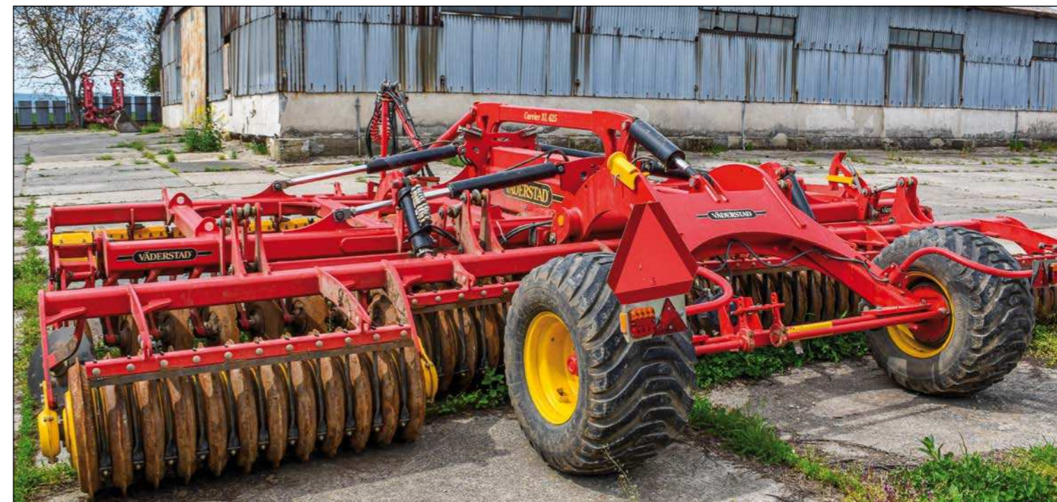
Diskové náradie Carrier XL 625, vybavené diskami s priemerom až 610 mm.
